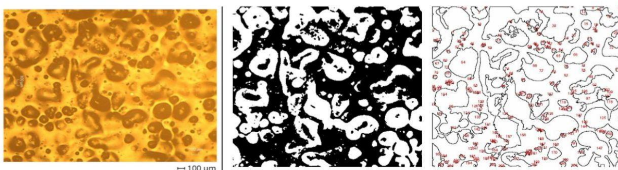
Figura 7 – Amostra C da peça nº 9×100: ampliação (1), tratamento de imagem (2) e contagem (3)
