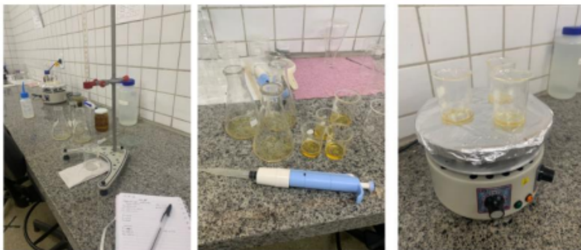
Figura 5 - Imagens do experimento realizado para a obtenção dos dados de acidez volátil pelo método de titulação ácido-base.
