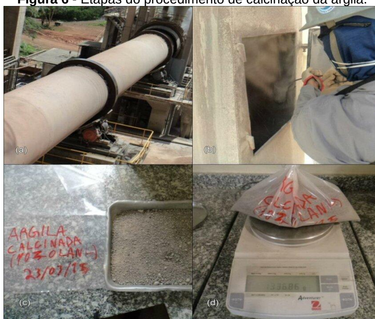
Figura 6 - Etapas do procedimento de calcinação da argila.
