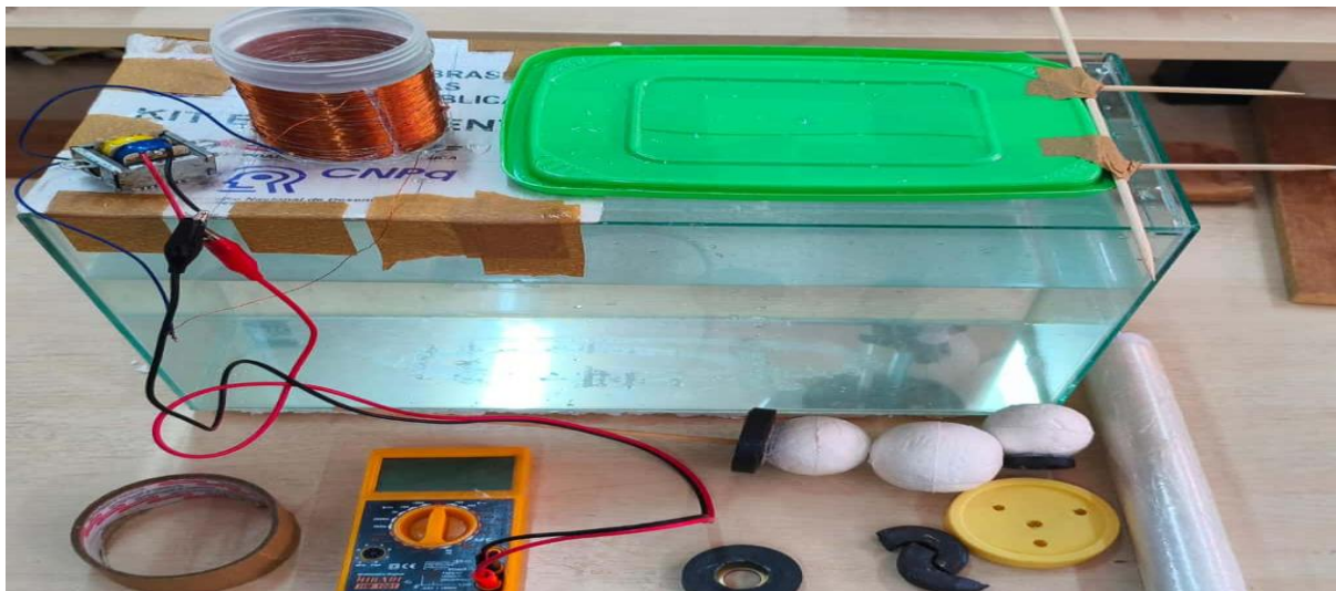
Figura 8 – Todos os itens utilizados na montagem do protótipo experimental de conversão de energia maremotriz.
