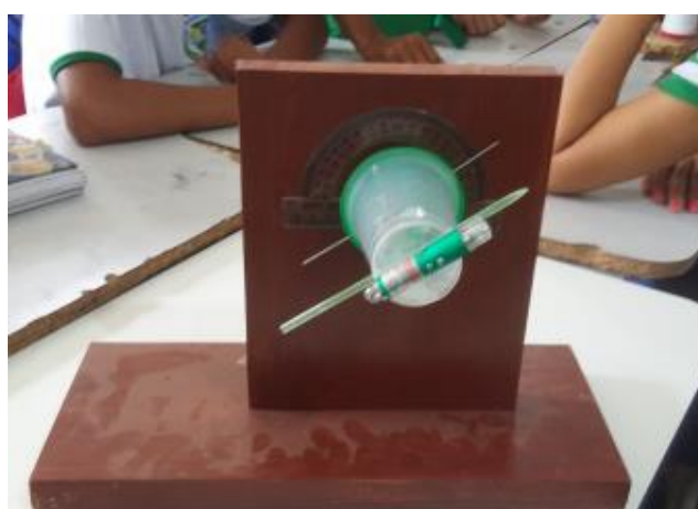
Figura 01: Exemplo de teodolito caseiro
