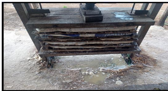
Figura 6 - Prensagem da massa de mandioca lavada
