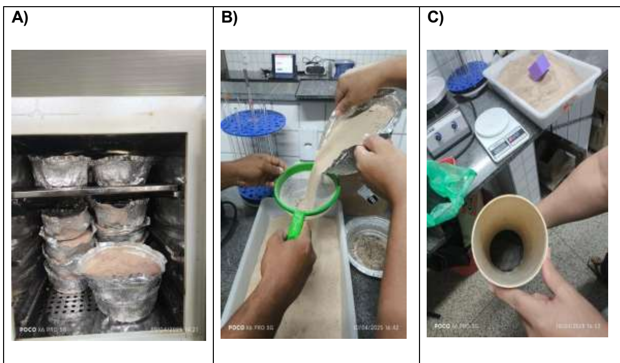
A - Secagem da areia para coleta de efluentes; B - retirada de materiais indesejados na areia; C - Minissilos com areia e tela de proteção
