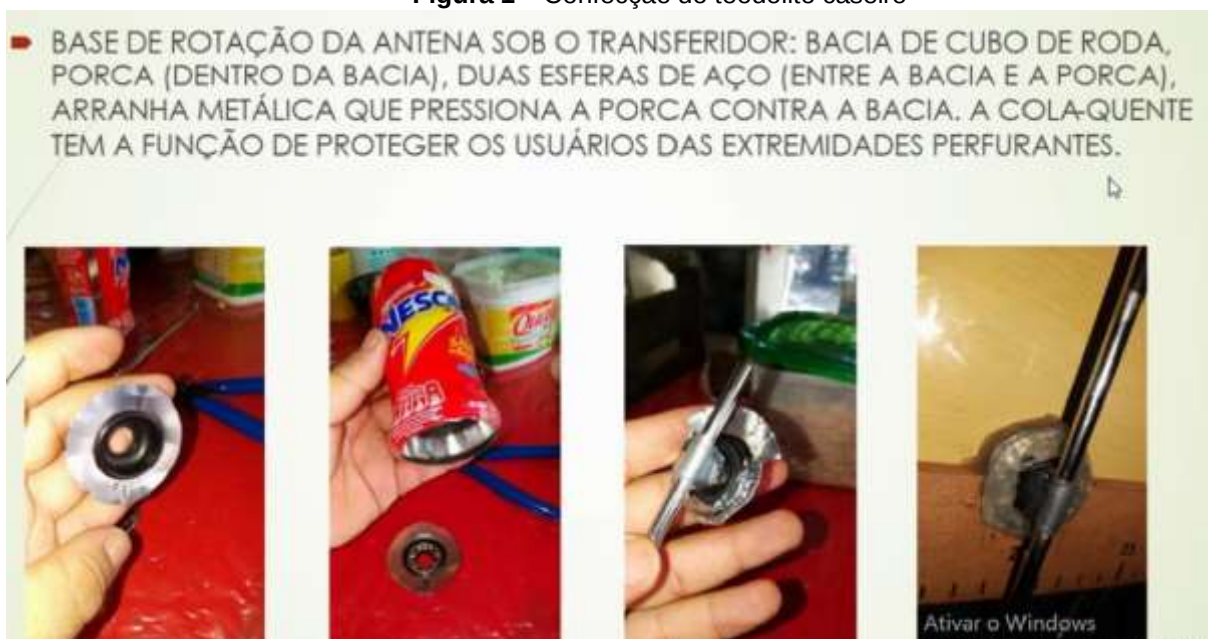
Figura 1 – Confeção do teodolito caseiro
