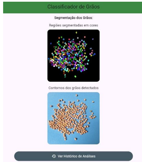
Figura 16 - Tela com imagem mostrando contorno e segmentação dos grãos
