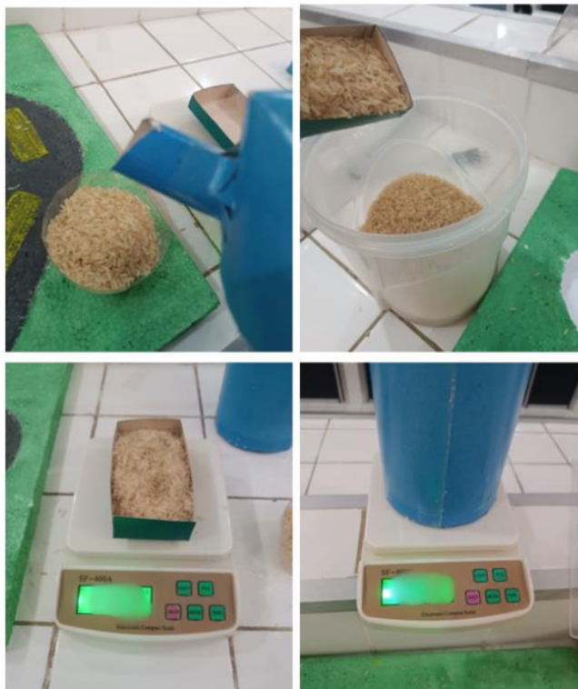
Figura 8 – Validação experimental do modelo do silo por meio da pesagem do arroz
