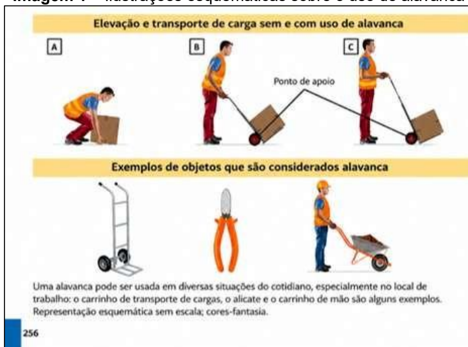
Imagem 1 – Ilustrações esquemáticas sobre o uso de alavanca
