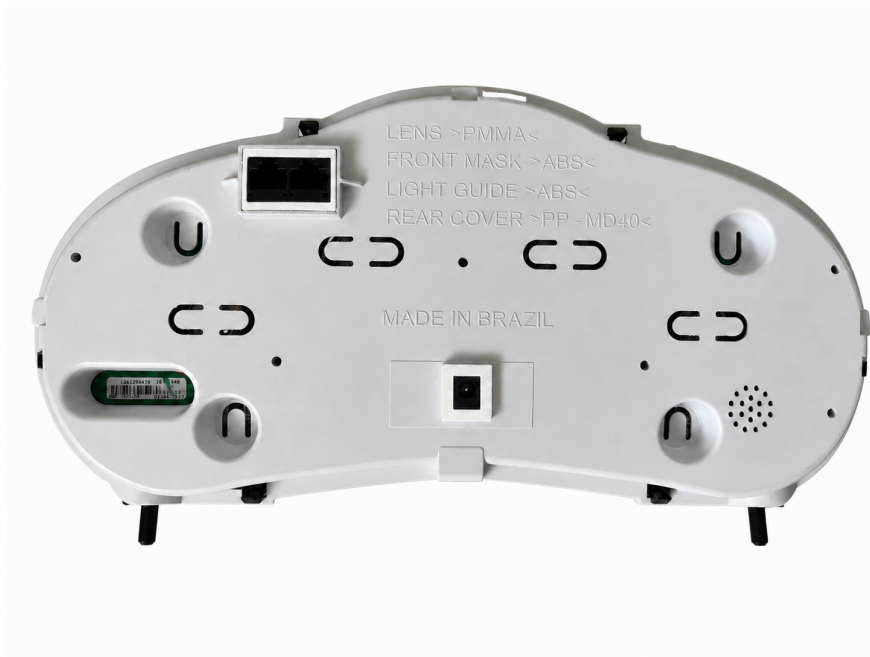
Figura 13 – Visão traseira do painel com as conexões de alimentação e interfaces externas.
