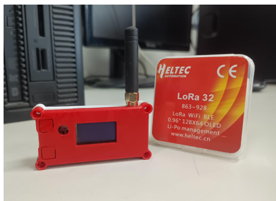
Figura 1 – Módulo Heltec WiFi LoRa 32 V2 em case impressa em 3D com antena de 915 MHz.
