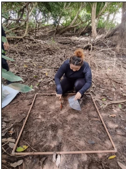
Figura 12 - Coleta de solo simples
