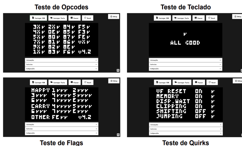
Figura 16 – Execução de ROMs de teste
