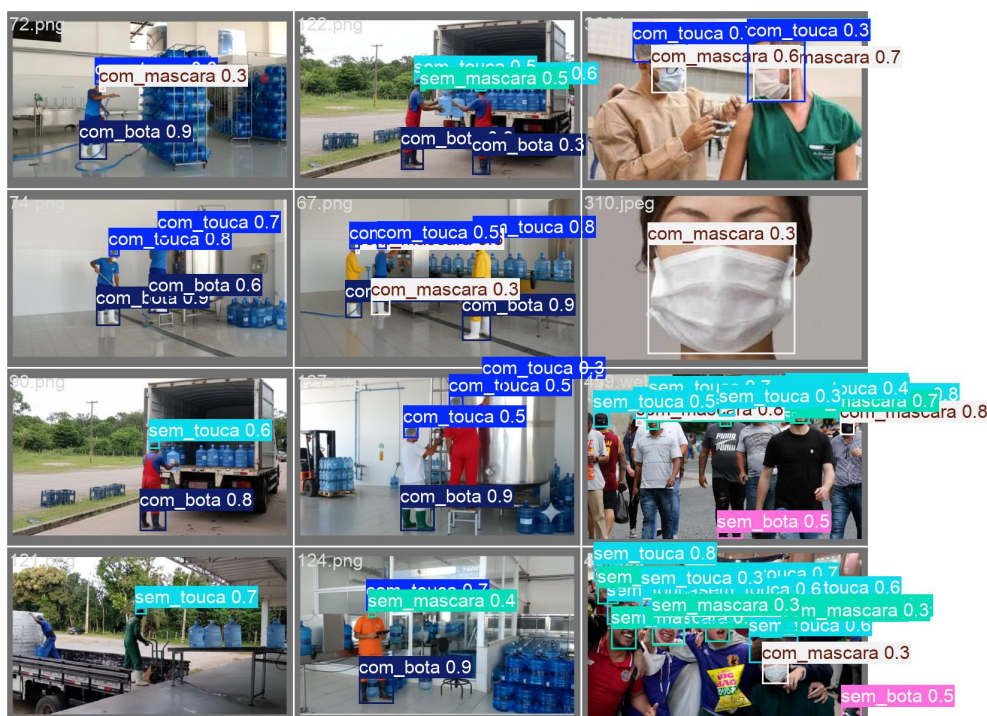
Figura 6 – Exemplos de detecções de EPIs realizadas pelo modelo YOLOv8n
