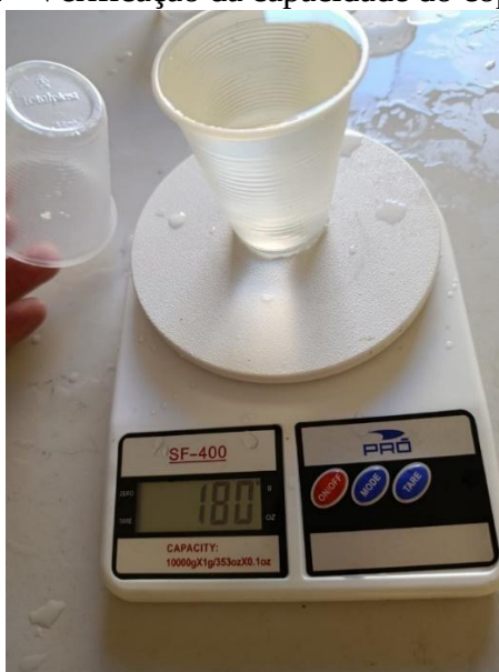
Figura 14 - Verificação da capacidade do copo maior
