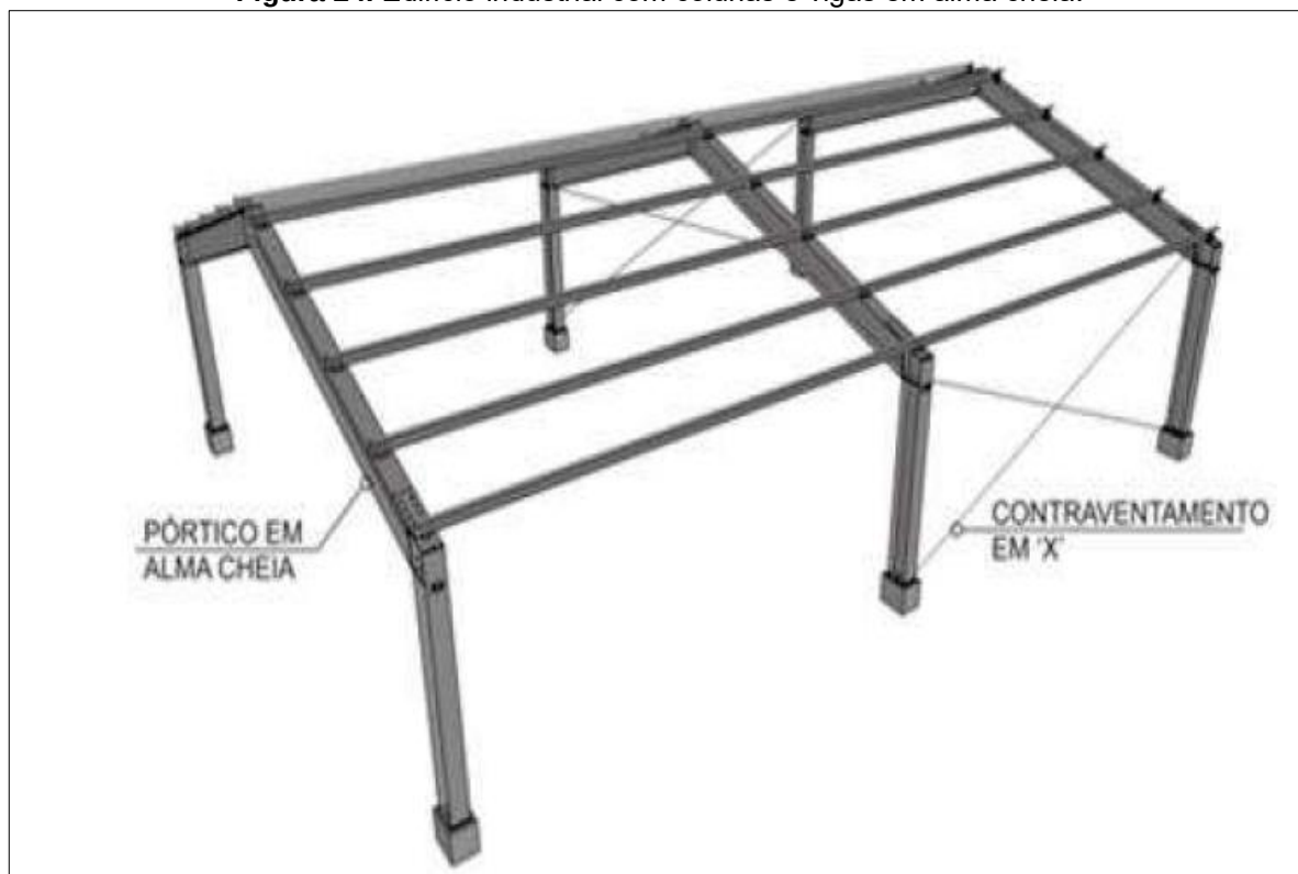
Figura 24. Edifício industrial com colunas e vigas em alma cheia.
