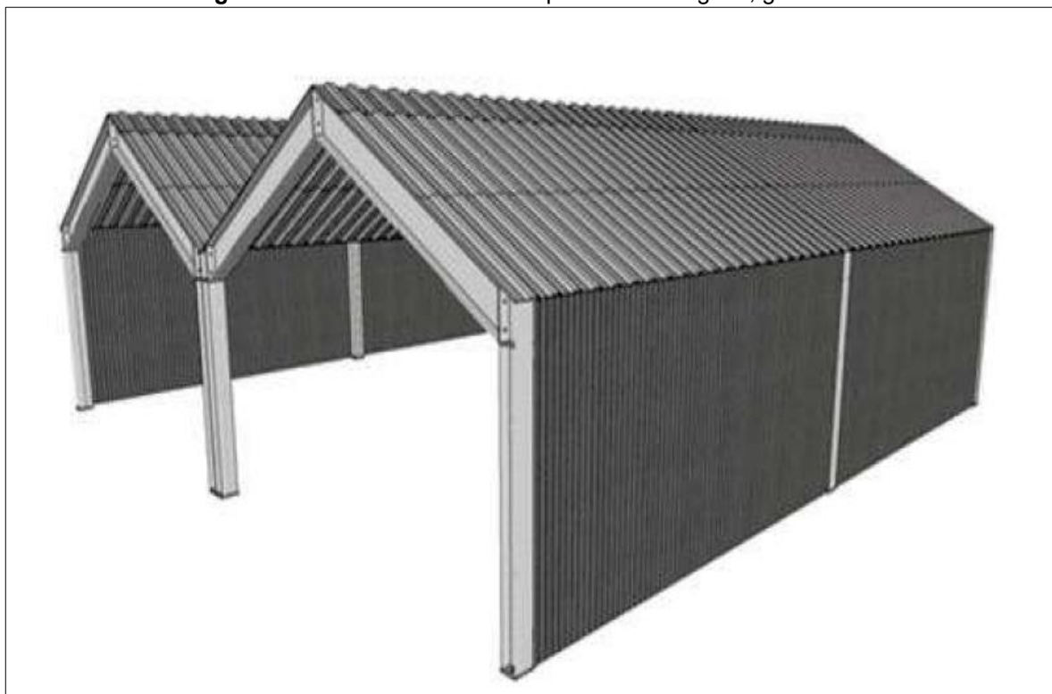
Figura 27. Edifício industrial em quatro meias-águas, geminado.
