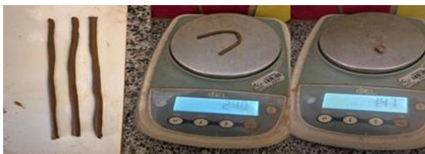
Figura 16 - Ensaio de Limite de Plasticidade (LP) realizado na pesquisa
