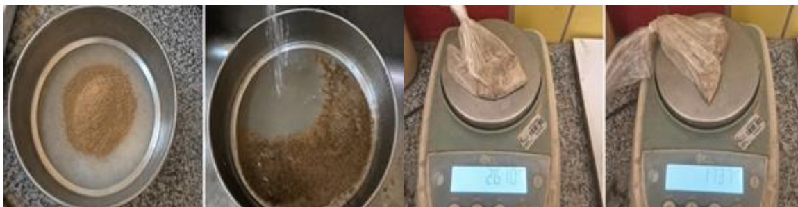
Figura 13 - Ensaio de teor residual realizado na pesquisa
