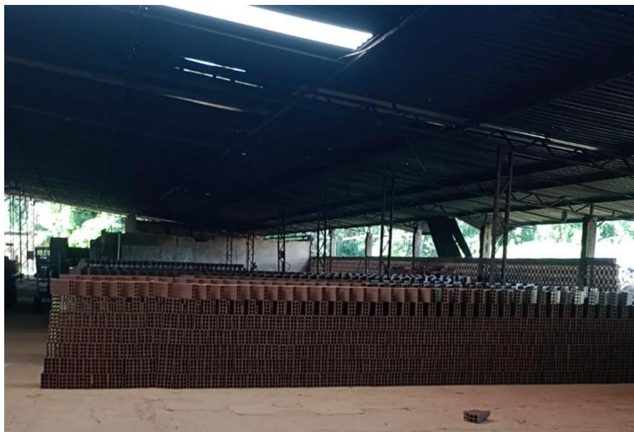
Figura 9 - Secagem natural de blocos de vedação
