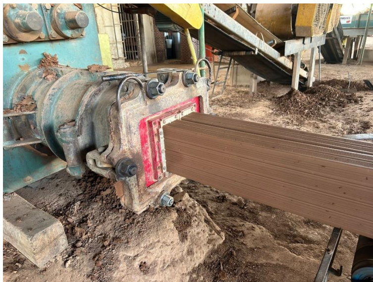
Figura 7 - Processo de extrusão de blocos de vedação
