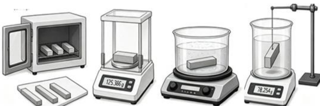
Figura 27 - Esquema do ensaio de porosidade aparente
