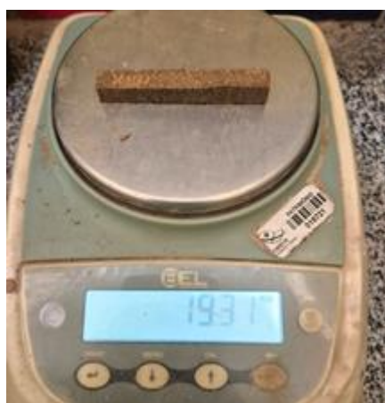
Figura 22 - Corpo de prova conformado
