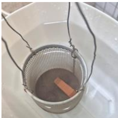
Figura 26 - Corpo de prova suspenso em recipiente com água
