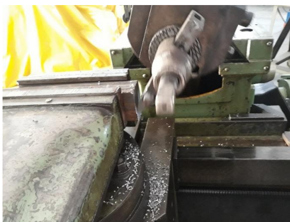
Figura 10. Obtenção de medidas do projeto através de aplainamento
