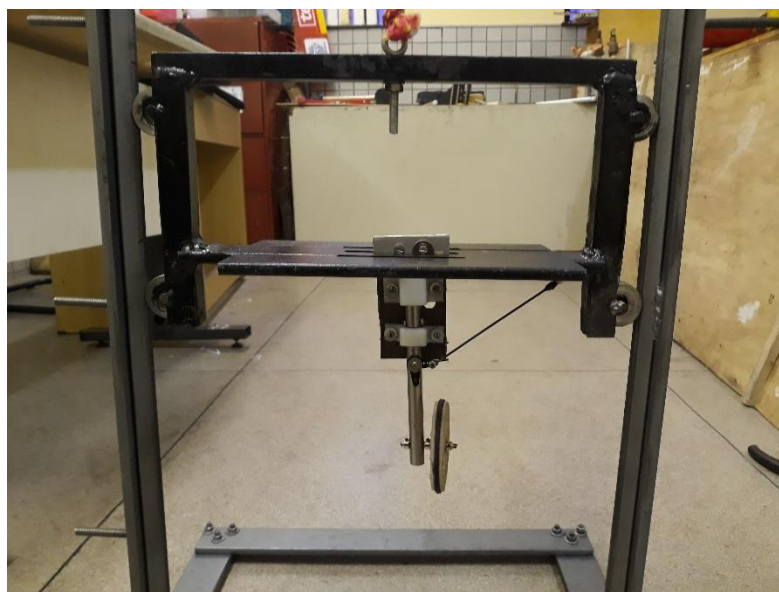
Figura 24. Demonstração da realização de ensaio em bequilha
