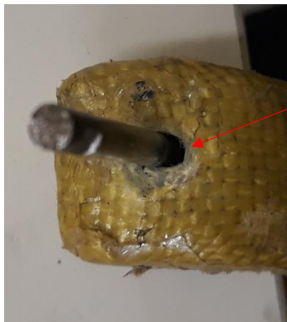
Figura 20. Falha decorrente de ensaio realizado no protótipo de 2017
