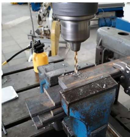
Figura 13. Processo de abertura de furos
