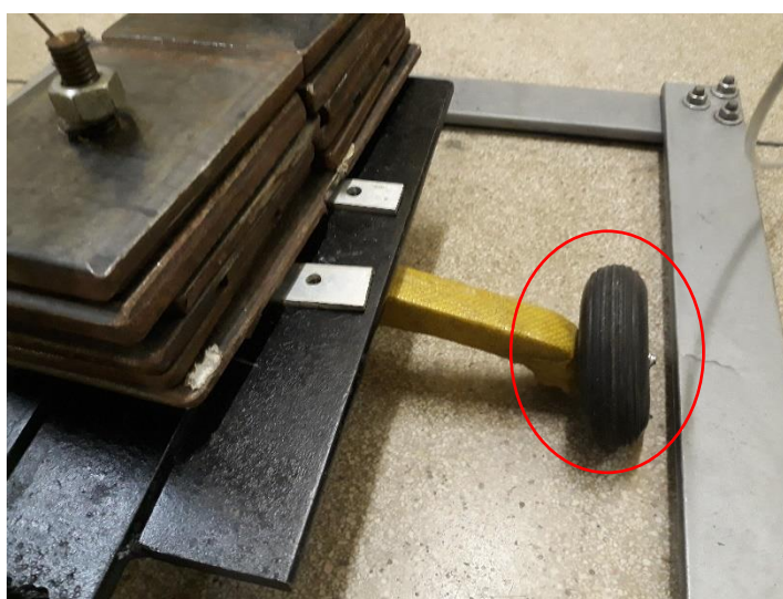
Figura 19. Empeno da roda após ensaios
