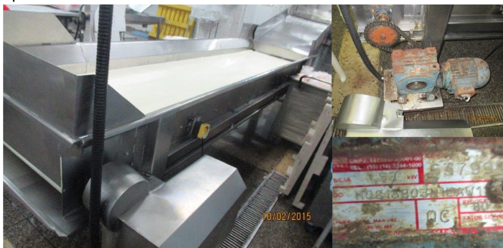
Figura 12 - Cestari com destaque para coroa e corrente com ferrugem aparente
