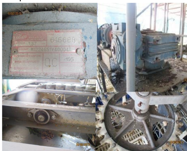
Figura 17 - Plaqueta, rolamentos e componentes da lavadora de caixas
