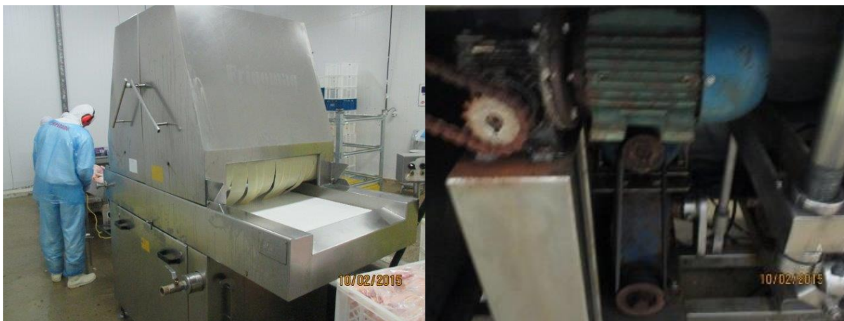
Figura 6 - Injetora de temperos, à direita elementos enferrujados
