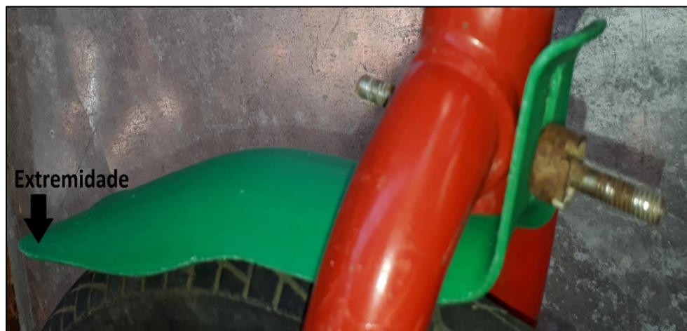
Figura 26 – Teste do paralama dianteiro na bicicleta infantil
