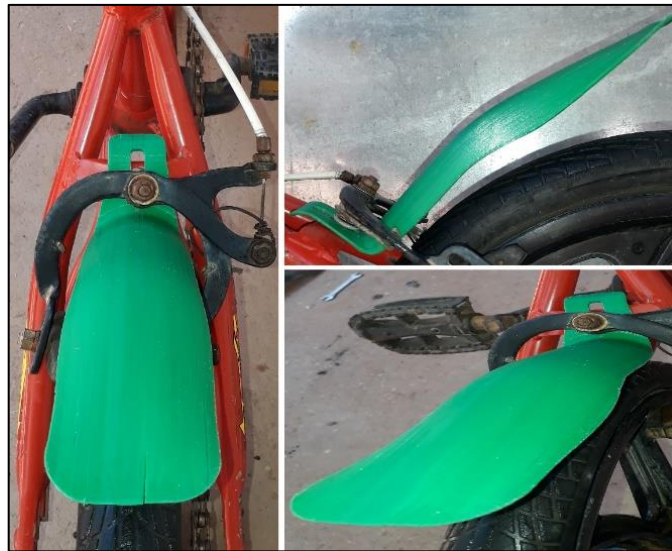
Figura 27 – Teste do paralama traseiro
