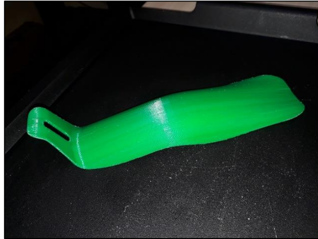
Figura 18 – Paralama impresso na impressora 3D XYZ Printing
