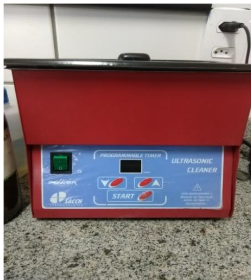
Figura 7 – Equipamento de ultrassom utilizado na limpeza das brocas.
