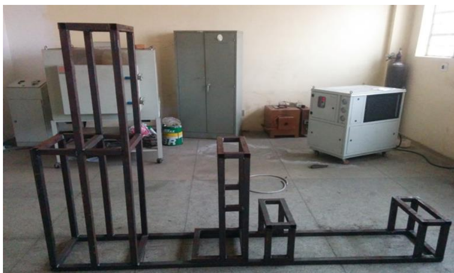
Figura 4 – Estrutura base da bancada composta por aço carbono SAE 1020 de perfil quadrado.
