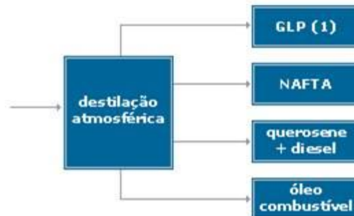
Figura 1 - Esquema de produção de derivados de petróleo nível 1
