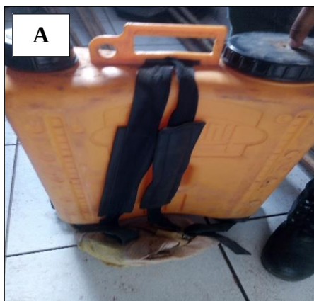
Figura 2: A - Bomba costal usada para controlar focos de incêndios logo no início. B - Abafadores usados no controle de queimadas para abafamento das chamas.
