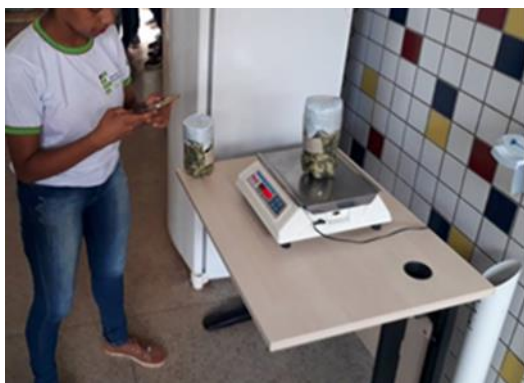
Figura 2. Pesagem das garrafas PET identificadas e vedadas para determinação da quantidade de milho picado e posterior cálculo da densidade da silagem.
