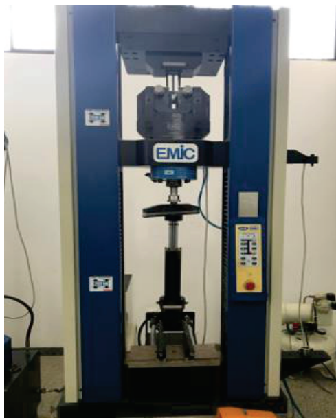
Figura 5.2-Máquina EMIC DL20000 no laboratório de ensaios mecânicos da universidade federal do Piauí
