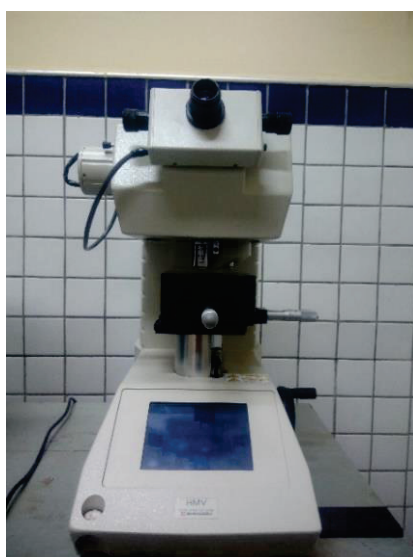
Figura 5.4-Microdurômetro de modelo HMV, fabricante Shimadzu
