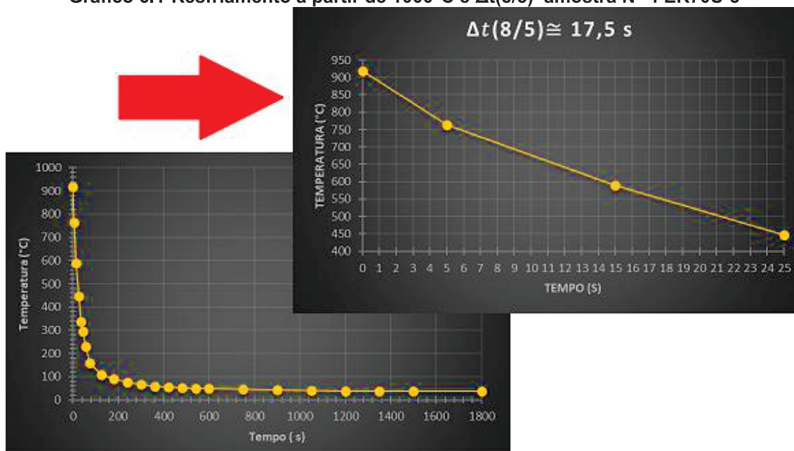
Gráfico 6.1-Resfriamento a partir de 1000°C e \Delta t(8/5) amostra N° 4 ER70S-3
