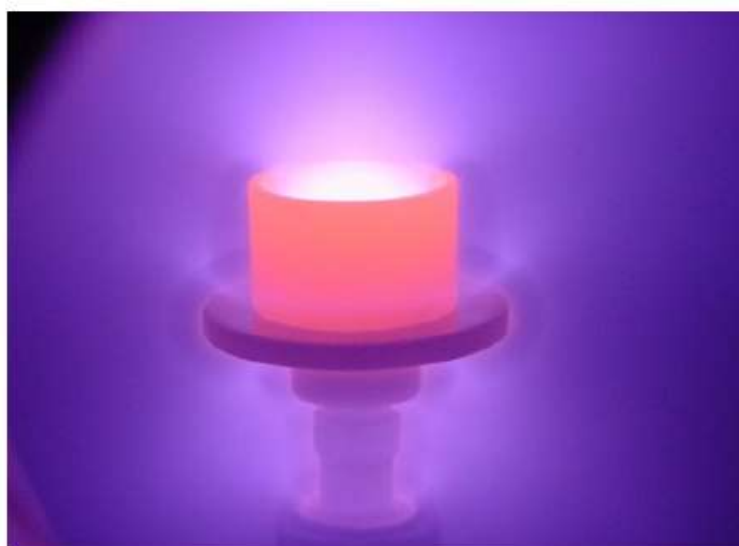
Figura 2-8: Efeito de cátodo oco em um cilindro via descarga CO. Fonte: Daudt (2012)
