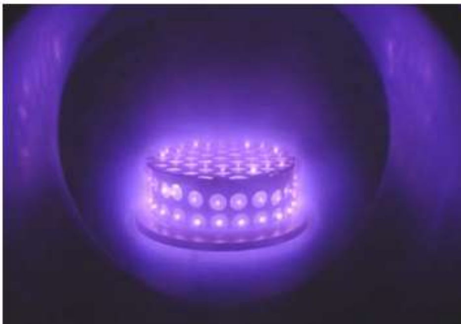
Figura 2-11: Plasma sendo formado na gaiola catódica
