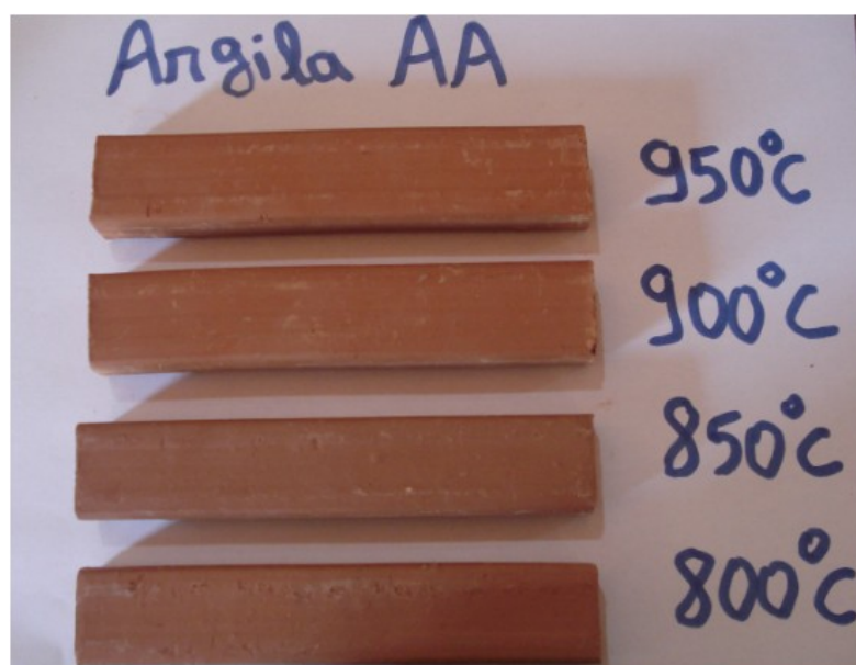
Figura 51 – Corpos de Prova da Argila AA nas temperaturas 950 °C, 900 °C, 850 °C e 800 °C.
