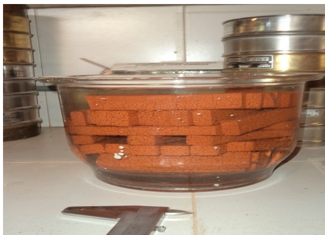
Figura 20- Imersão dos corpos de prova para análise de Absorção de água.
