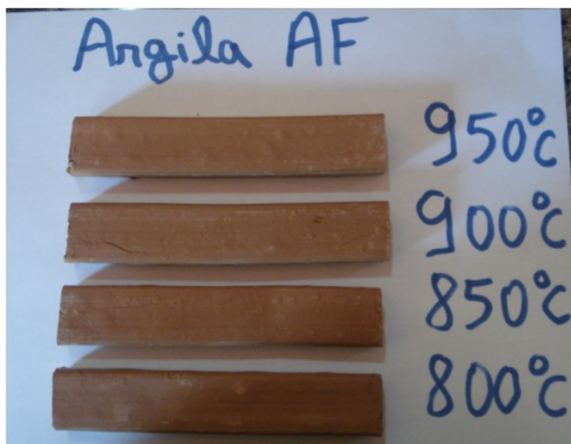
Figura 54 – Corpos de Prova da Argila AF nas temperaturas 950 °C, 900 °C, 850 °C e 800 °C.
