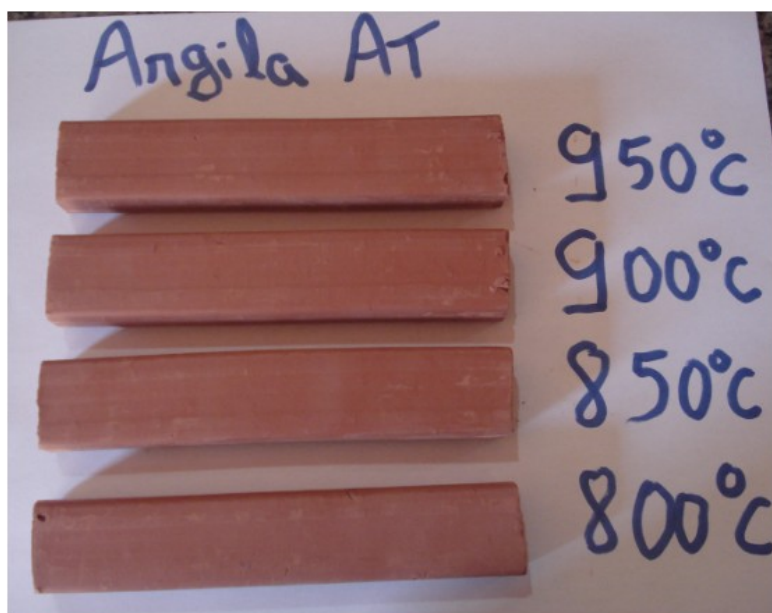
Figura 53 – Corpos de Prova da Argila AT nas temperaturas 950 °C, 900 °C, 850 °C e 800 °C.
