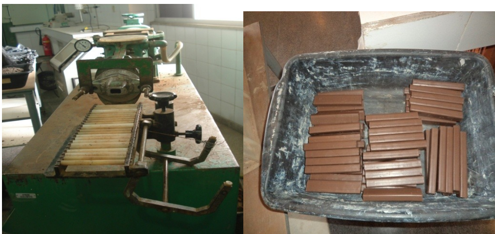
Figura 17 – Conformação dos Corpos de Prova por Extrusão
