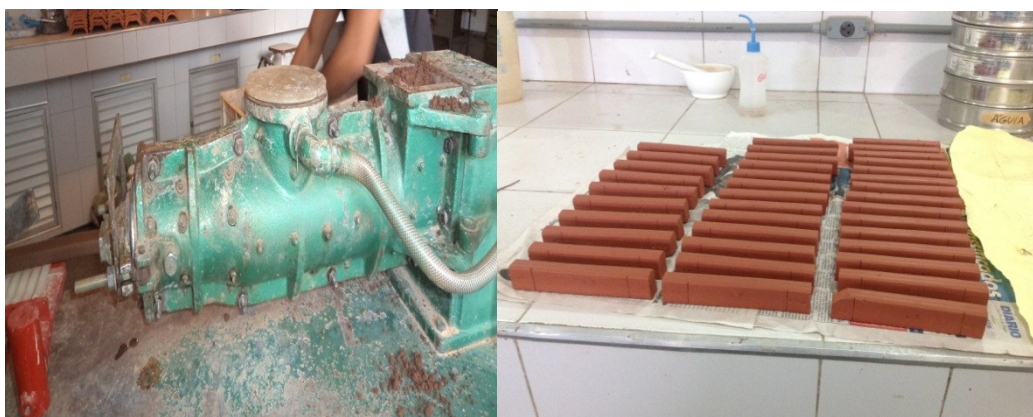
Figura 22- Confeção dos corpos de prova das formulações
