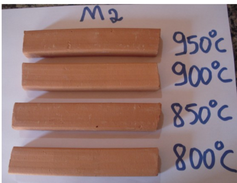
Figura 56 – Corpos de Prova da Formulação M2 nas temperaturas 950 °C, 900 °C, 850 °C e 800 °C.
