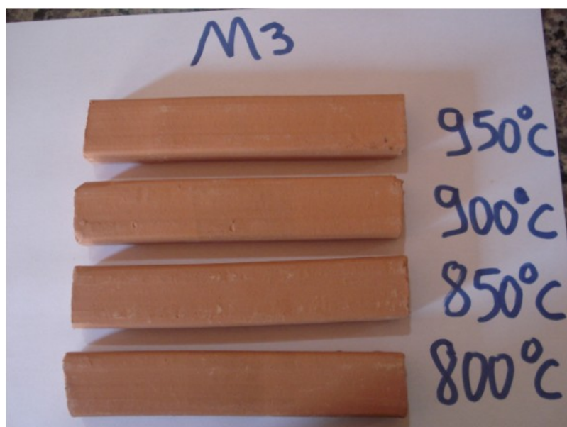
Figura 57 – Corpos de Prova da Formulação M3 nas temperaturas 950 °C, 900 °C, 850 °C e 800 °C.
