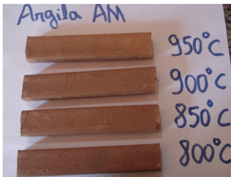
Figura 52 – Corpos de Prova da Argila AM nas temperaturas 950 °C, 900 °C, 850 °C e 800 °C.
