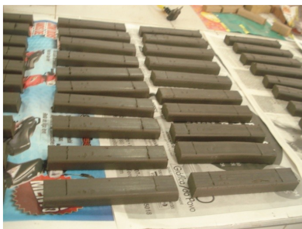
Figura 18 – Secagem dos Corpos de Prova a Temperatura Ambiente
