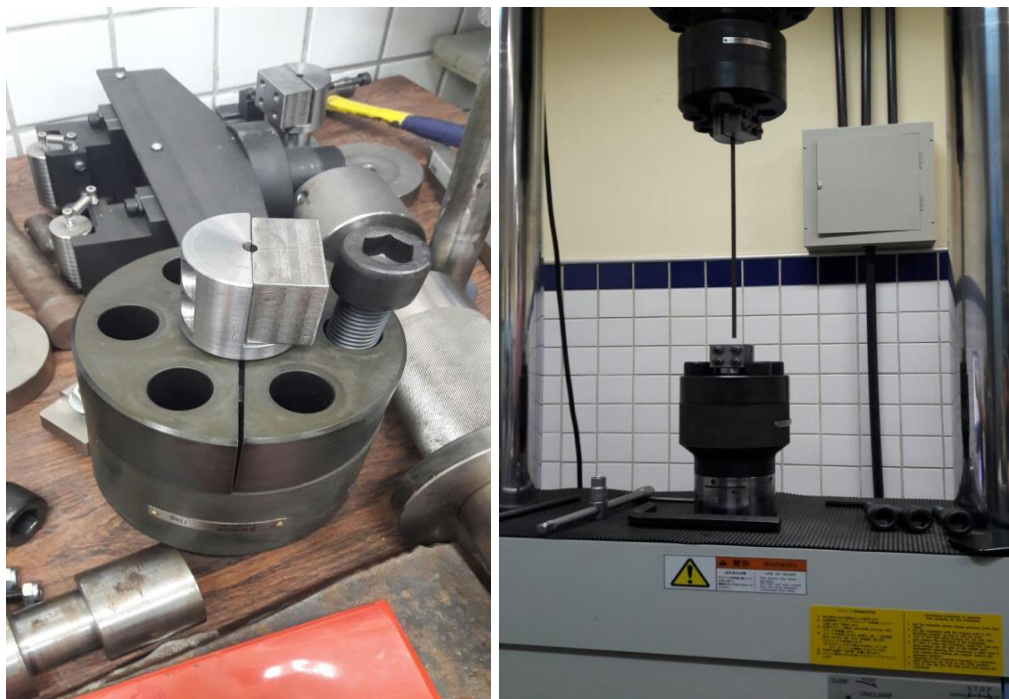
Figura 32 – (a) Mordente 01 acoplado na garra; (b) Deslizamento da barra na realização do ensaio (mordente 01)
