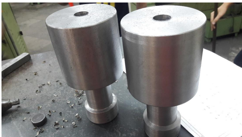
Figura 34 – Matriz do mordente 02 em processo de adaptação pelo torno
