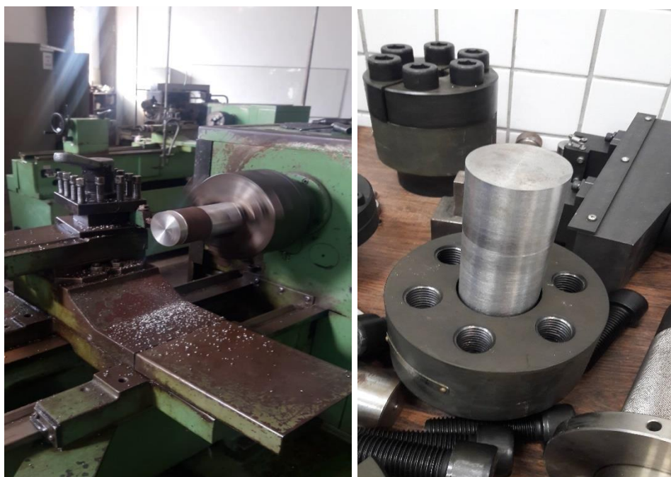
Figura 31 – (a) Fabricação do mordente no torno; (b) Aferição das dimensões atingidas no torno
