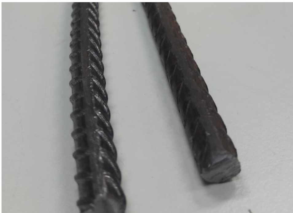
Figura 40 – Vista das nervuras dos aços CA-60 (Aço da esquerda: Fabricante B; aço da direita: Fabricante A)
