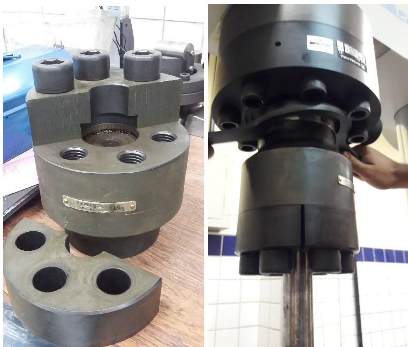
Figura 27 – (a) Detalhe da garra da SHIMADZU com dois diâmetros internos para acoplamento de corpo de prova; (b) Garra acoplada na máquina com o corpo de prova padrão da máquina encaixado na mesma
