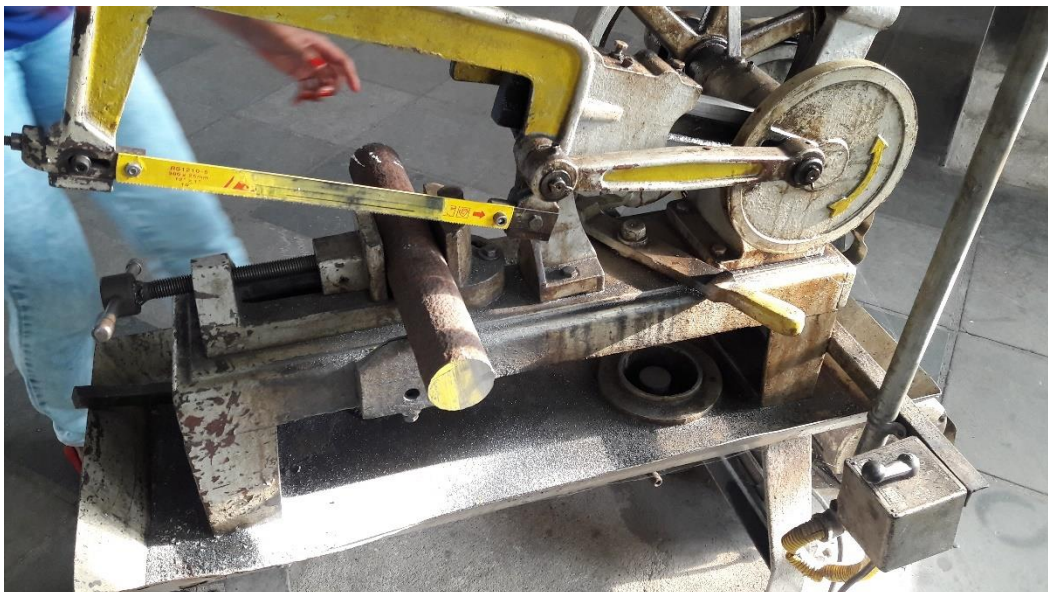
Figura 30 – Corte da peça em altura aproximada dos mordentes projetados
