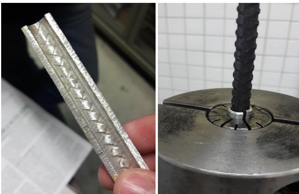
Figura 35 – (a) Semi-cana de alumínio com ranhuras internas ; (b) – Cunha interna ao mordente, o alumínio e o vergalhão
