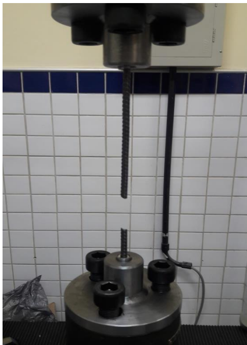
Figura 39 – Ruptura da barra fora do mordente
