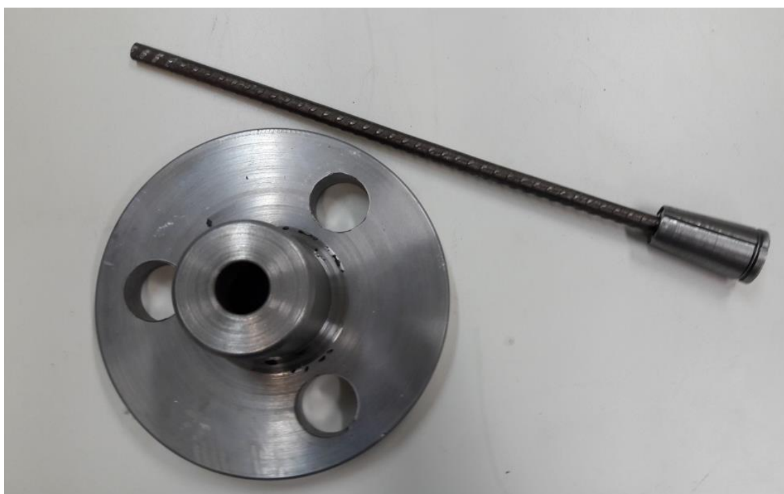
Figura 38 – Vista do mordente fabricado (Fixador cônico e cunha com semi-canais de alumínio)
