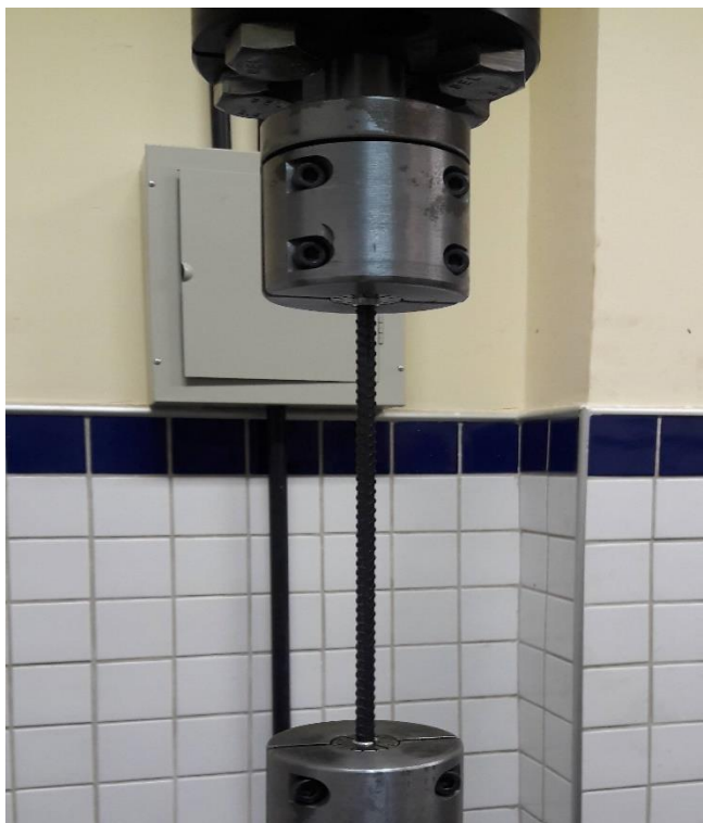
Figura 36 – Mordentes tipo 02 realizando a fixação do vergalhão na máquina
