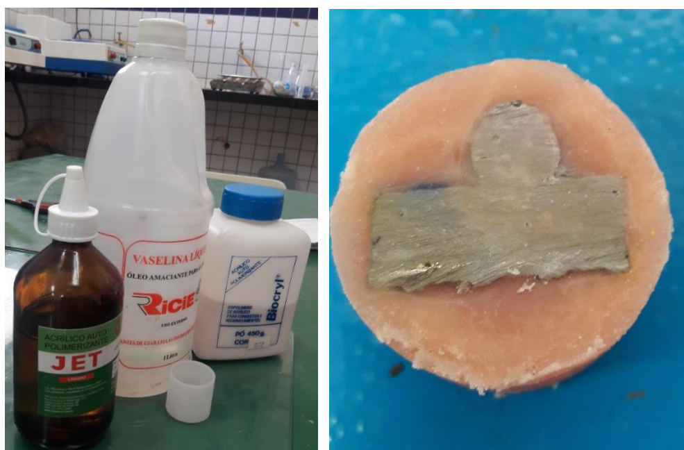
Figura 44 – Processo de embutimento da peça: (a) materiais utilizados; (b) peça embutida
