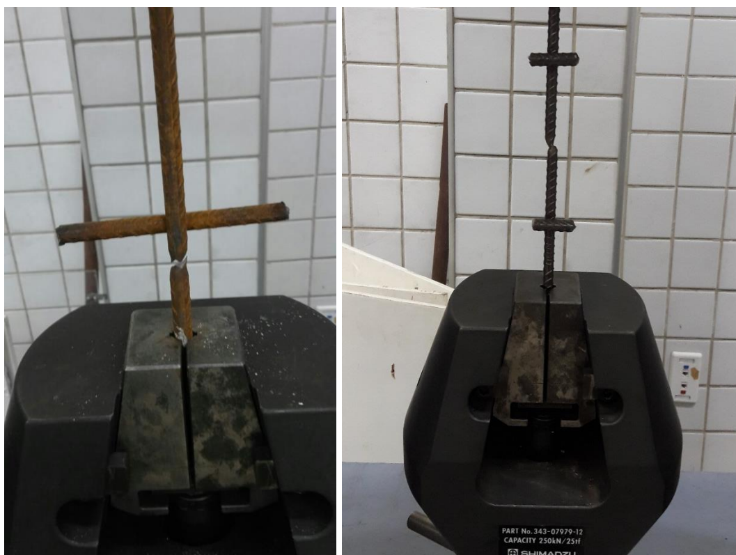
Figura 76 – (a) Estricção que gerou a ruptura – Tela Fabricante A; (b) – Estricção que gerou a ruptura – Tela Fabricante B
