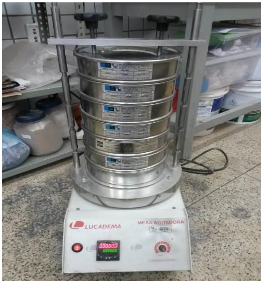
Figura 4.2 Peneiramento das amostras com agitador mecânico
