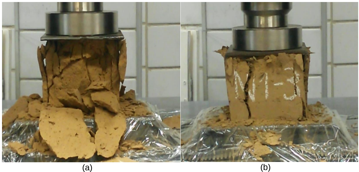
Figura 6.5 Ensaio de compressão simples. a) Grupo de controle. b) Grupo N1
