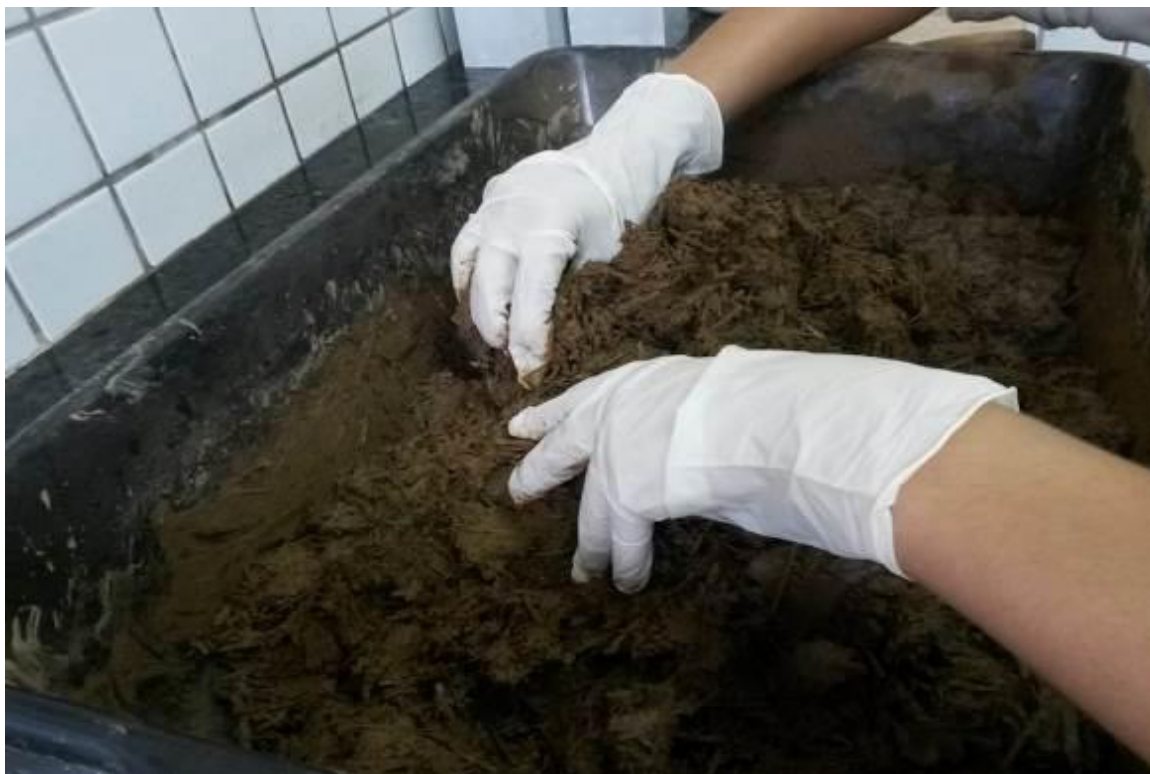
Figura 4.8 Amassamento da mistura de barro e palha com as mãos
