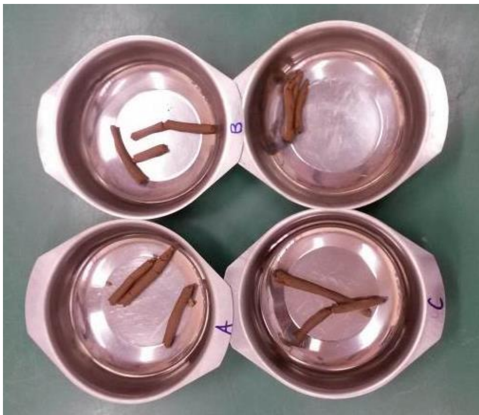
Figura 4.4 Cilindros do ensaio de limite de plasticidade
