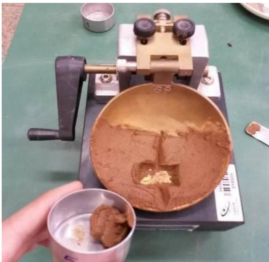
Figura 4.3 Porção de argila retirada do aparelho de Casagrande
