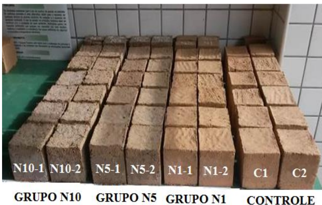
Figura 4.10 Cubos identificados expostos ao sol durante a secagem
