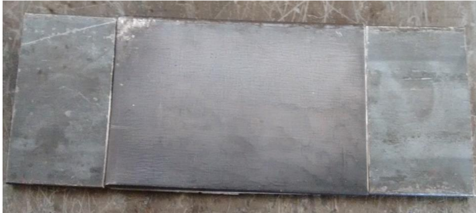
Figura 6 – Corpo de prova pronto para a soldagem.
