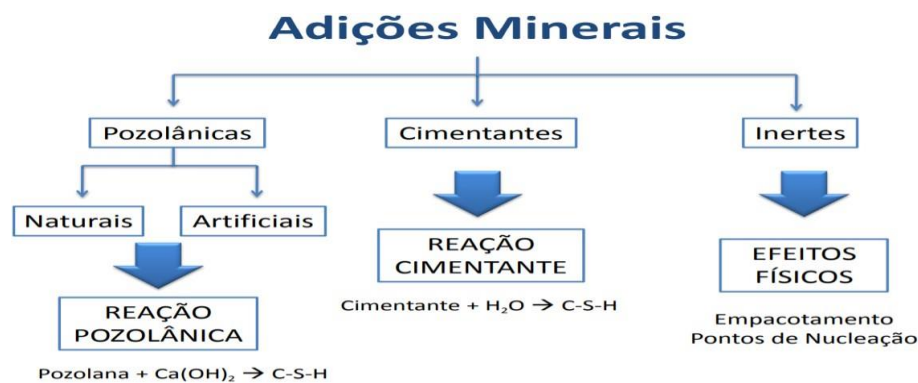
Figura 10 – Funcionamento das adições minerais no CAA
