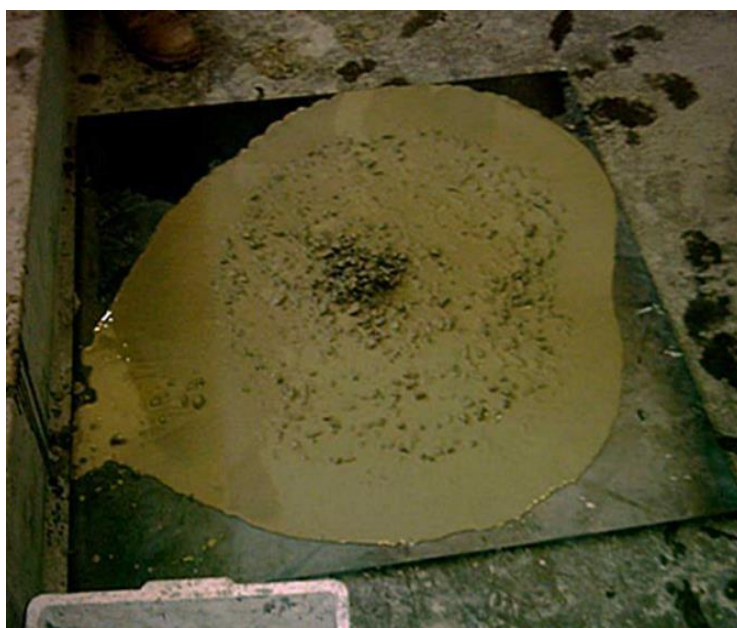
Figura 17 – CAA com visível segregação
