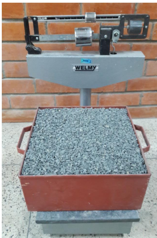
Figura 58 - Determinação da massa do recipiente com o agregado graúdo
