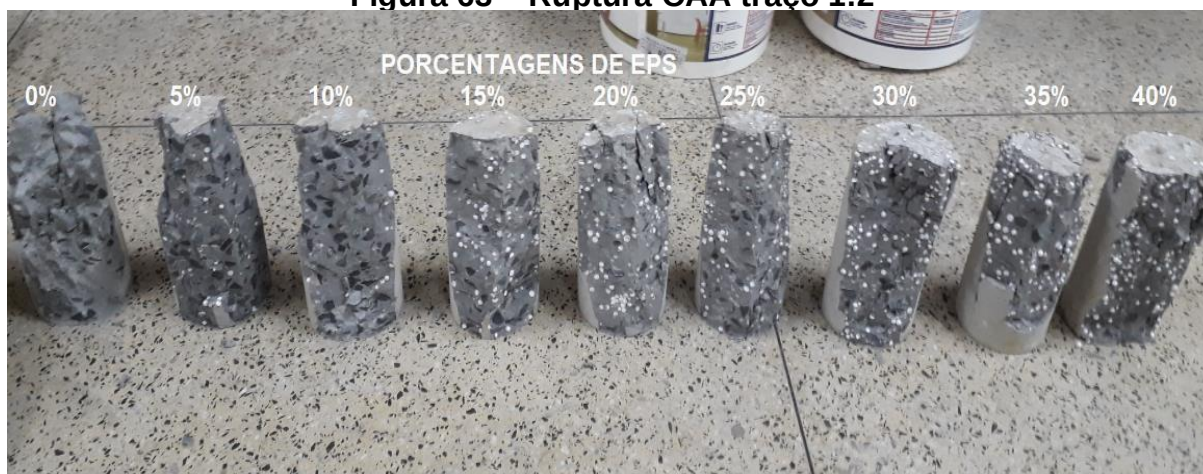
Figura 63 – Ruptura CAA traço 1:2
