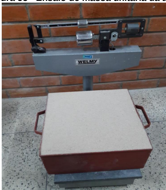
Figura 55 - Ensaio de massa unitária da areia
