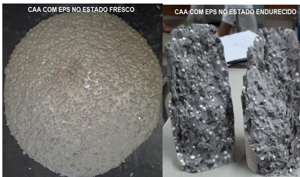
Figura 68 - Ausência de segregação do EPS no CAA
