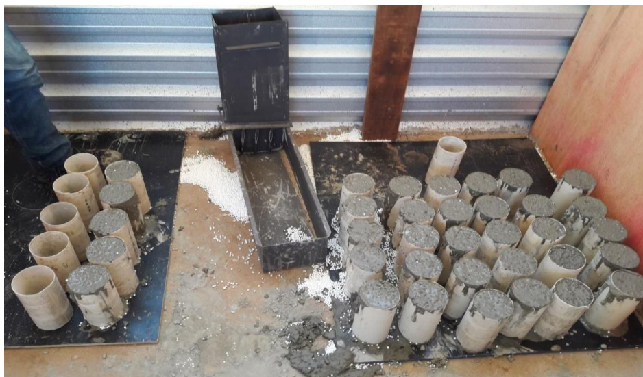
Figura 61 - Moldagem do CAA
