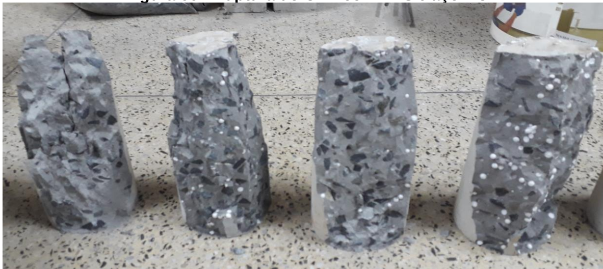
Figura 66 - Ruptura do CAA com EPS traço 1:3
