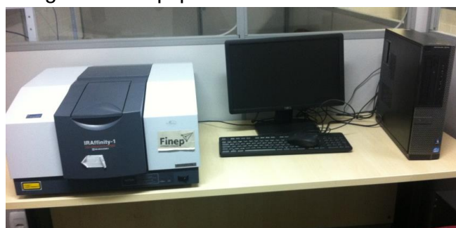
Figura 15- Equipamento de Infravermelho
