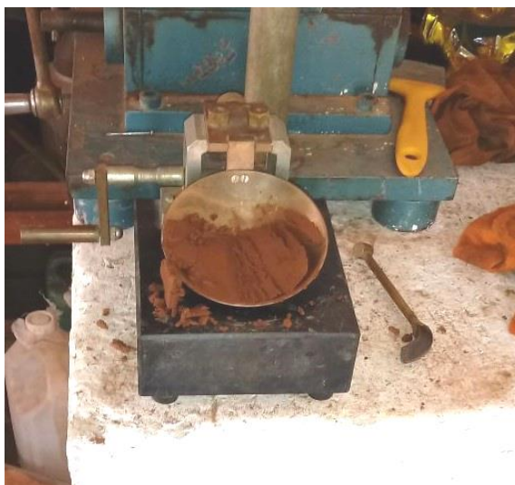
Figura 16 - Ensaio do Limite de Liquidez.
