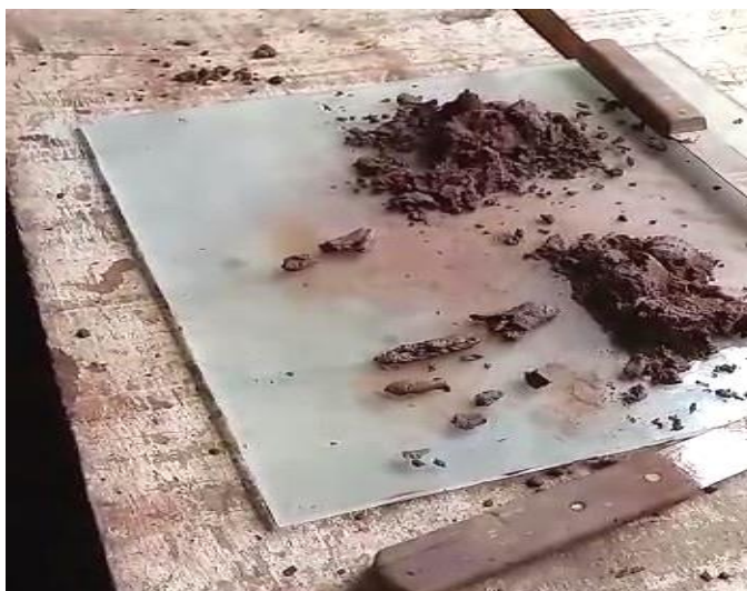
Figura 17 – Ensaio do Limite de Plasticidade.
