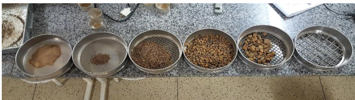
Figura 15 – Peneiramento do solo laterítico.
