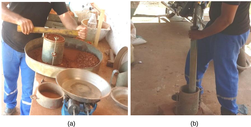
Figura 19 – Ensaio de Compactação.
