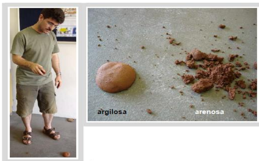
Figura 7 – Teste da queda da bola: aspectos do espalhamento, em função do tipo de terra (argilosa, à esquerda e arenosa à direita)
