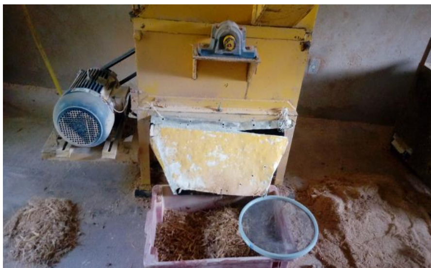
Figura 16 – Máquina para extração da fibra de coco babaçu
