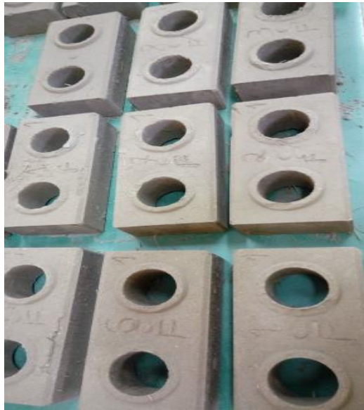
Figura 19 – Identificação dos tijolos após a prensagem
