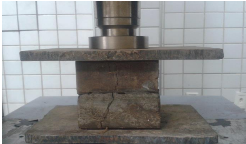
Figura 39 – Detalhe do aspecto da fratura do tijolo solo-cimento com adição da fibra de coco babaçu
