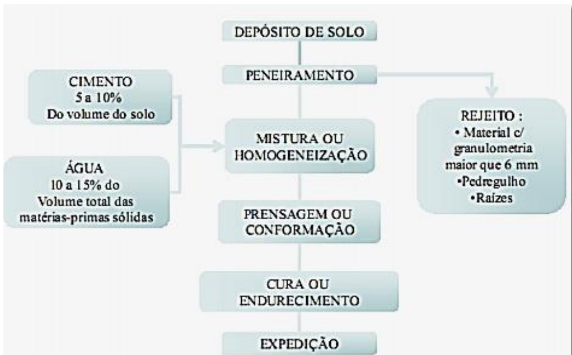
Figura 1 – Fluxograma do processo de fabricação do tijolo solo-cimento
