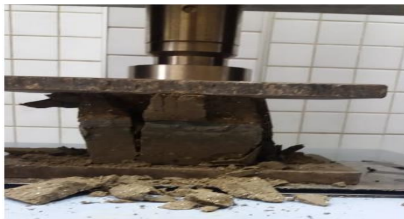
Figura 38 – Detalhe do aspecto da fratura do tijolo solo-cimento sem adição da fibra de coco babaçu
