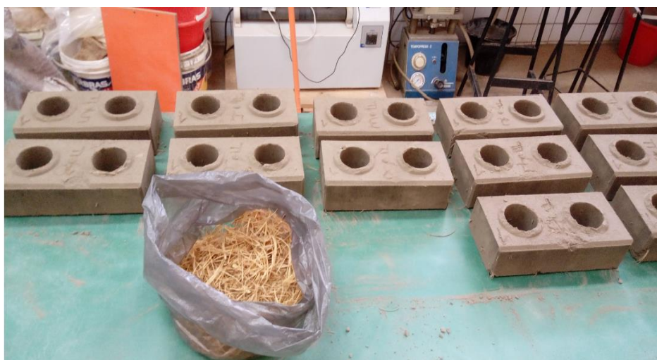
Figura 32 – Aspecto da superfície dos tijolos ecológicos reforçado com 2% de fibra de coco babaçu.
