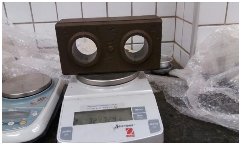
Figura 21 – Pesagem do corpo de prova seco
