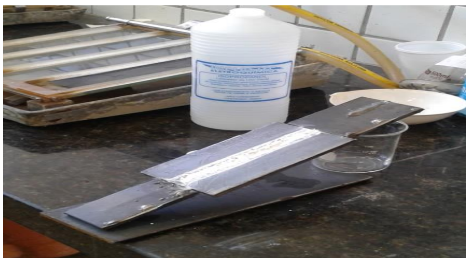
Figura 14 – Fluxo ativo fixado na peça
