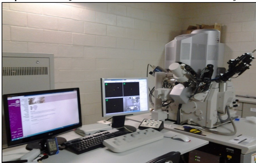
Figura 20 - Microscópio Dual de Feixe de Íons e Elétrons com Canhão por Emissão - FIB para realização das análises das amostras de aço
