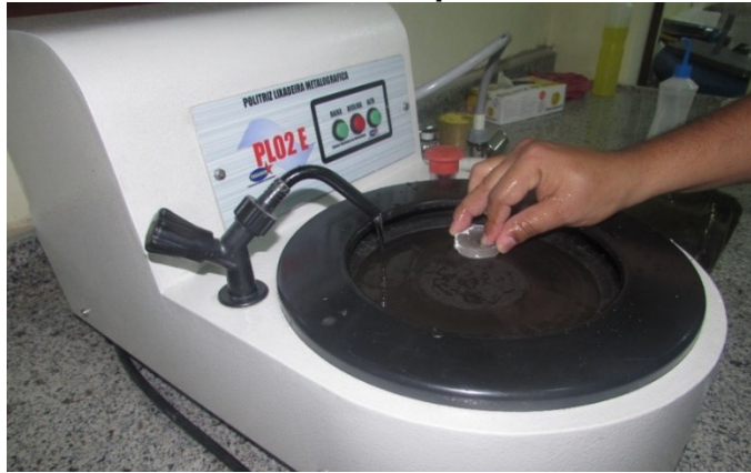
Figura 14 - Politriz usada no processo de lixamento
