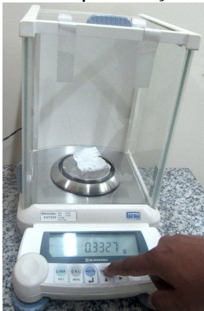
Figura 17 - Balança de Precisão para medição da massa das amostras.
