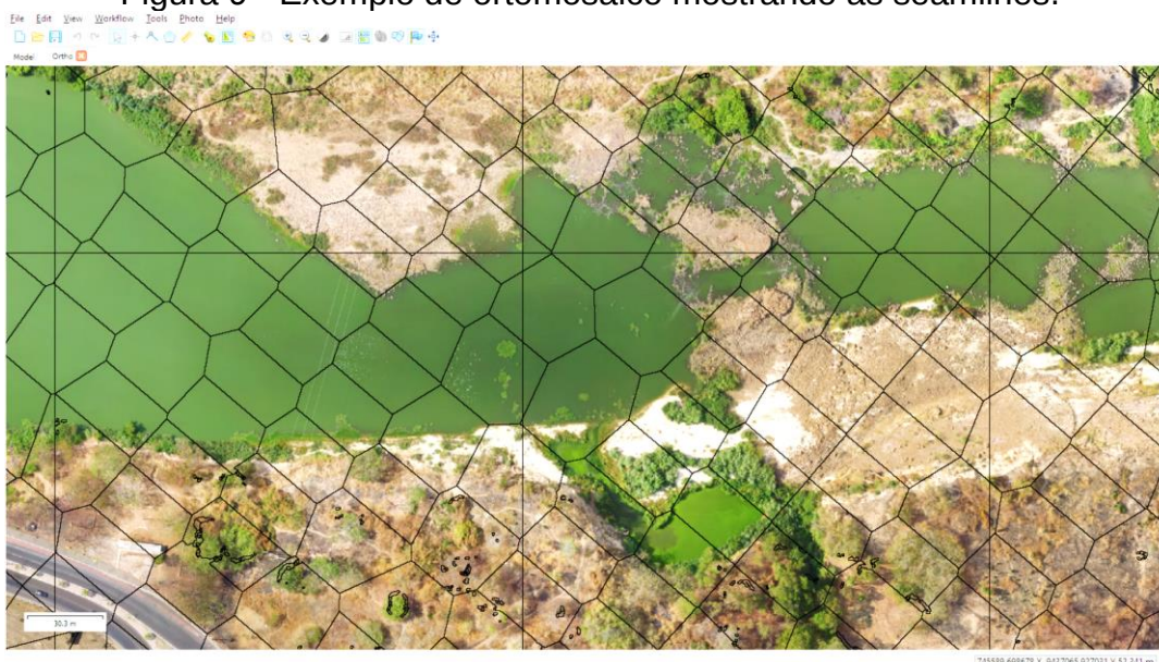
Figura 9 - Exemplo de ortomosaico mostrando as seamlines.
