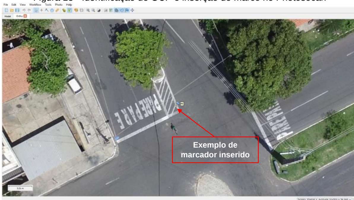
Figura 18 - Identificação de GCP e inserção de marco no Photoscan
