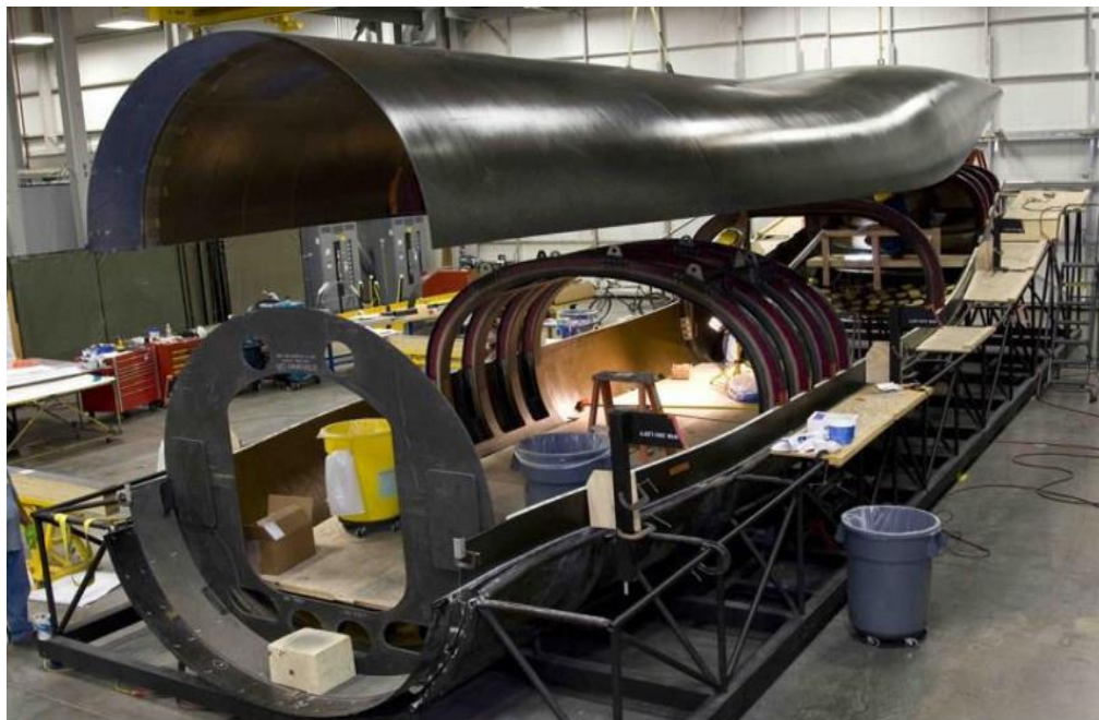
Figura 14: Mostra a fuselagem de um avião cargueiro, construída a parti de materiais Compósitos.
