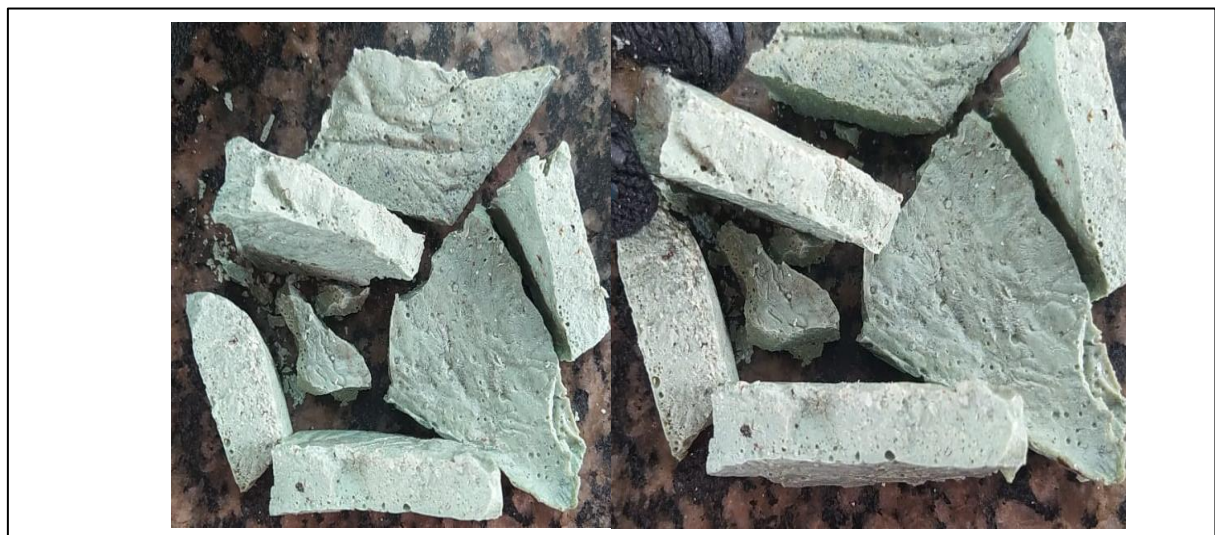
Figura 31 – Quebra do compósito B1 (segunda ordem).
