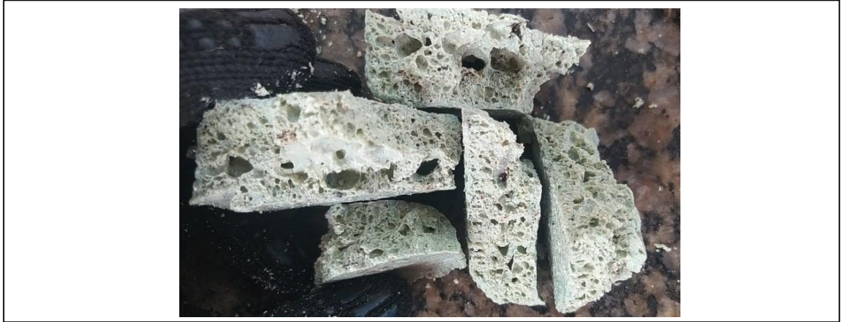
Figura 43 – Quebra do compósito C4 (segunda ordem).
