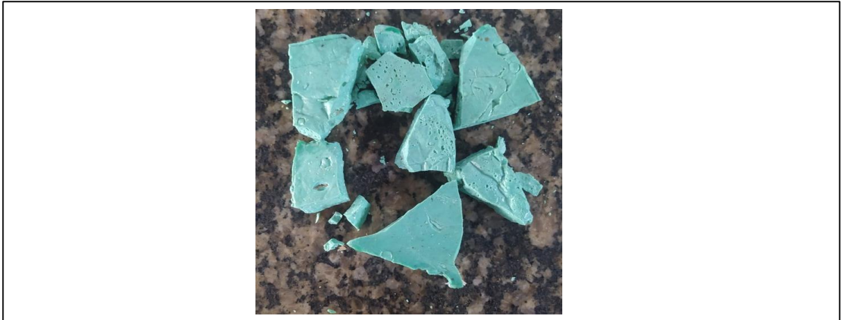
Figura 37 – Quebra do compósito C1 (segunda ordem).
