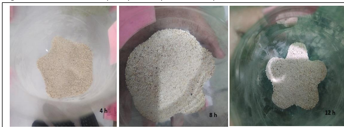
Figura 23 – Amostras de pó aquecido (4h, 8h e 12h).
