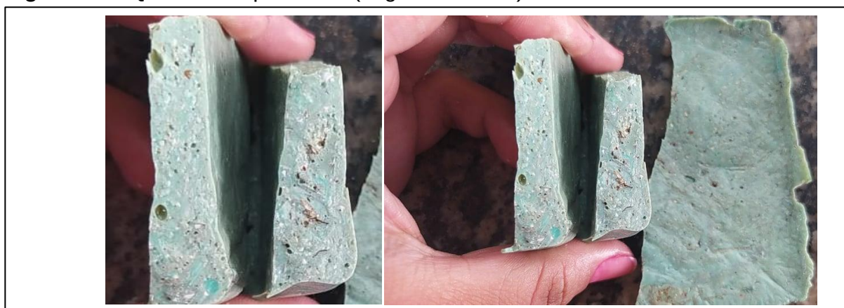
Figura 33 – Quebra compósito B2 (segunda ordem).
