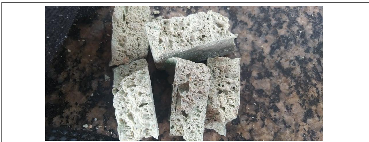
Figura 47 – Quebra do compósito C6 (segunda ordem).
