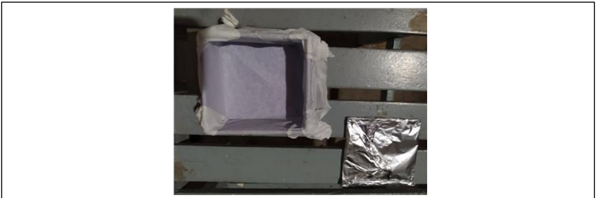
Figura 15 – Molde pronto para receber a mistura.
