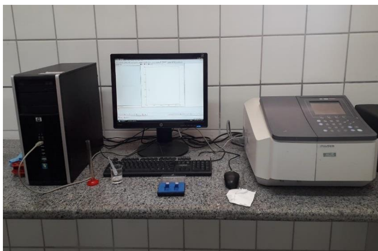
Figura 11– Aparelho utilizado para o UV-vis
