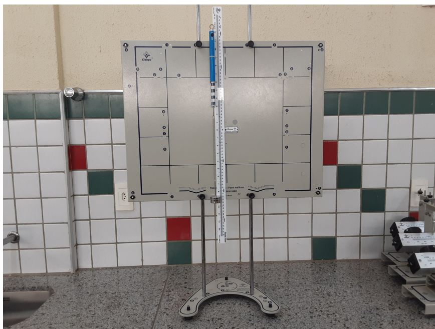
Figura 6.6 – Aparato experimental para determinação da constante da mola.
