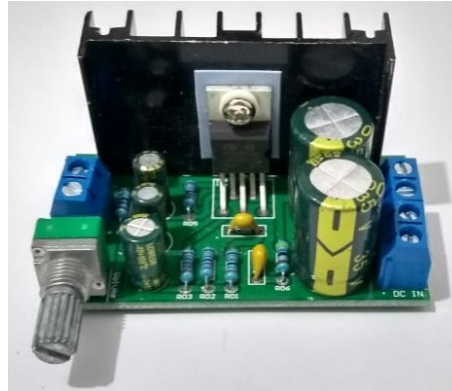
Figura 15 – Módulo amplificador TDA2050
