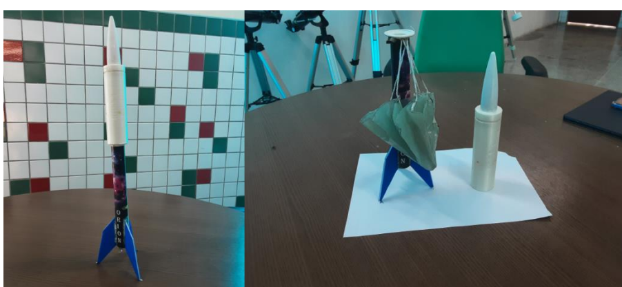
Figura 16 – Minifoguete Rose 1 adaptado com novo estágio de carga
