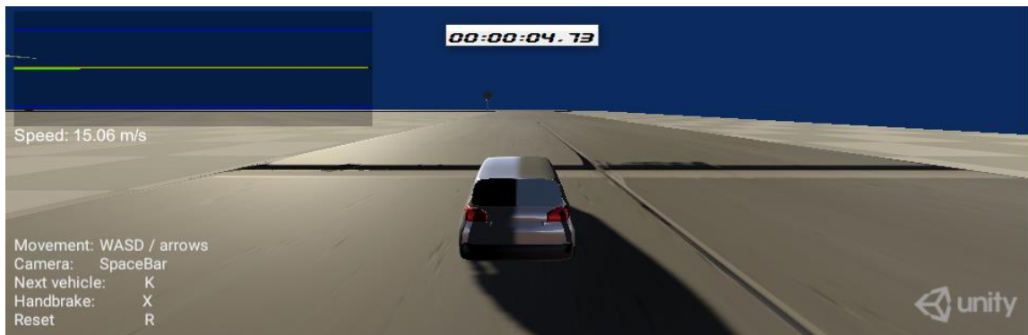
Figura 22: Medição do tempo levado para o carro obter a velocidade de 15m/s. Fonte: Autoria Própria Conclui-se, então, que a aceleração média deste veículo é:
