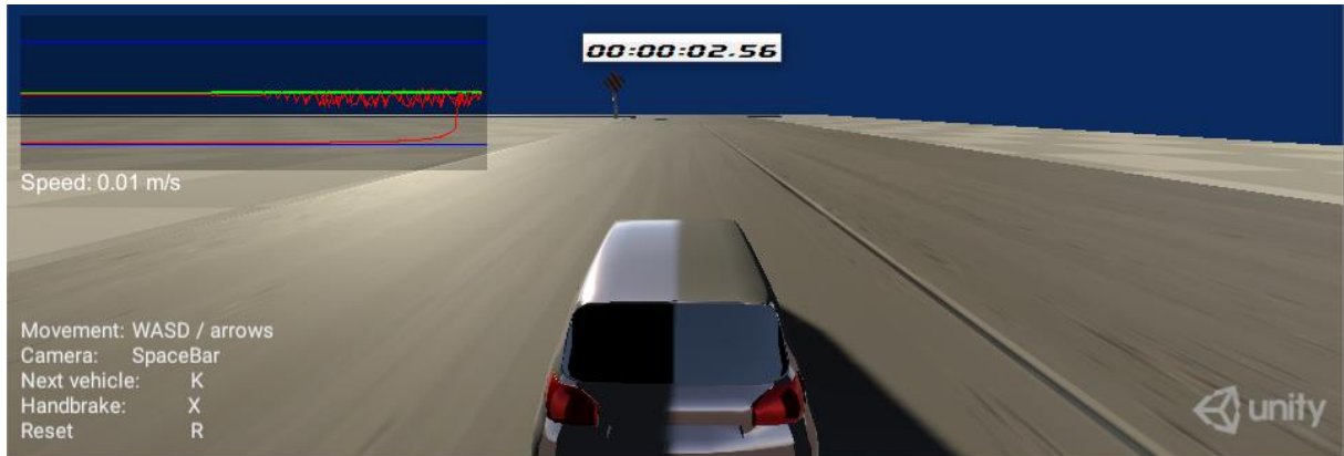
Figura 23: Medição do tempo levado para o carro chegar ao repouso a partir da velocidade de 15m/s usando o freio. Fonte: Autoria Própria
