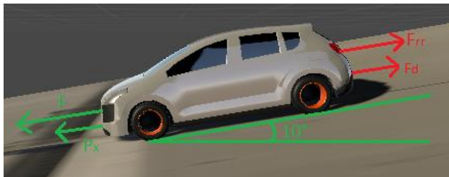
Figura 24: Diagrama de possíveis forças horizontais a atuar no veículo na posição (-700, -37, 370) sobre a rampa. Fonte: Autoria Própria
