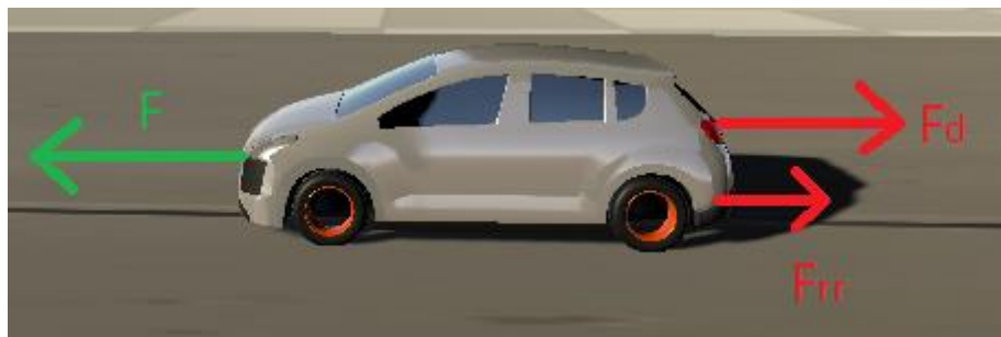
Figura 21: Diagrama de forças horizontais do veículo na seção horizontal plana do circuito. Fonte: Autoria Própria
