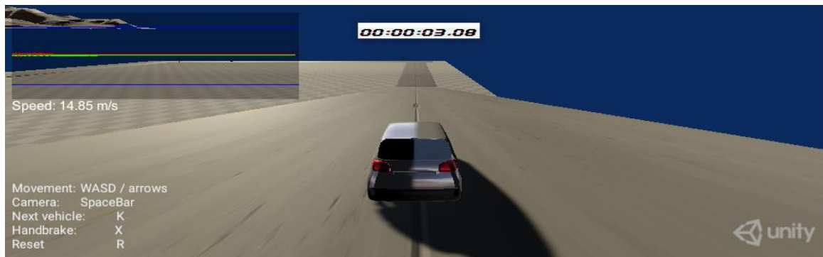
Figura 25: Medição do tempo para o carro obter uma velocidade de 15m/s na descida. Fonte: Autoria Própria
